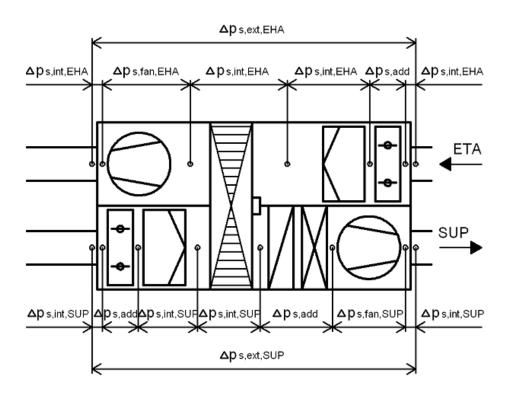
Die **spezifische Ventilatorleistung** *SVL*<sub>int</sub> (SFP<sub>int</sub>) ist die einem Ventilator gelieferte elektrische Leistung in Verbindung mit der Druckdifferenz aller (verordnungsrelevanten) Lüftungskomponenten (Filter, Wärmerückgewinnung und entsprechendes Gehäuse mit Luftstromein- und -ausgang) geteilt durch den Luftstrom in m³/s unter Auslegungslastbedingungen.
