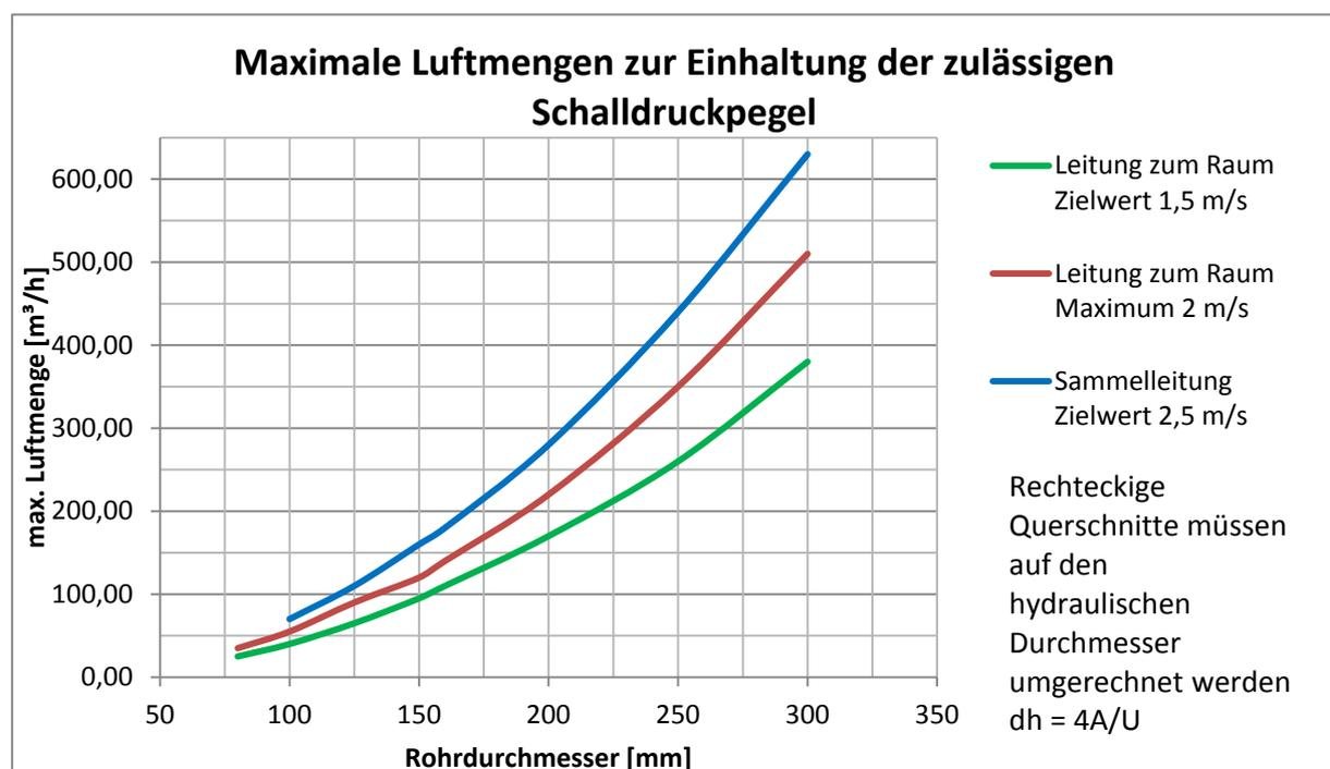
Abbildung 15: Maximale Luftmengen bei unterschiedlichen Rohrdurchmessern
