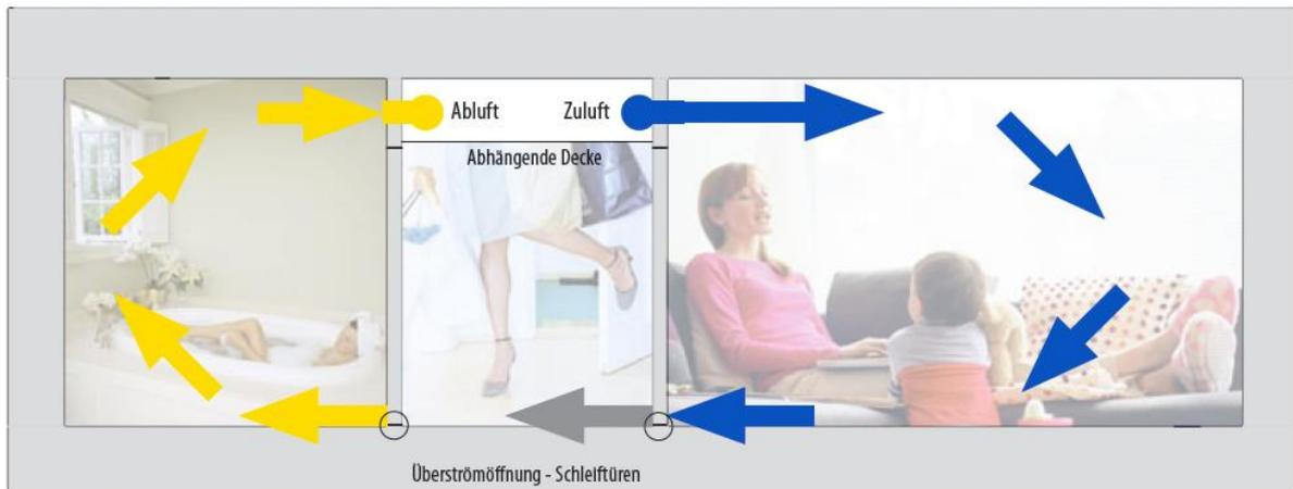
Abbildung 26: Schematische Darstellung eines Induktionslüftungssystems (Gremel, 2013)
