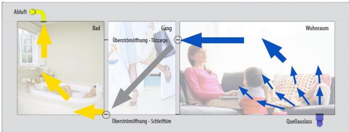
Abbildung 24 Schematische Darstellung eines Quelllüftungssystems (Gremel, 2013)
