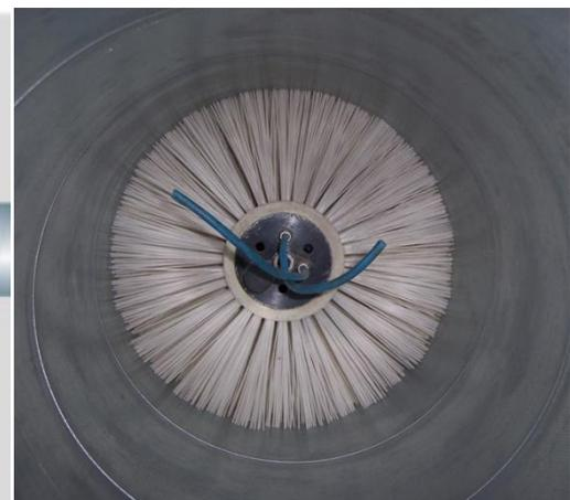
Abbildung 19 Reinigungsbürste (Quelle: <http://www.luft.ag/>)
