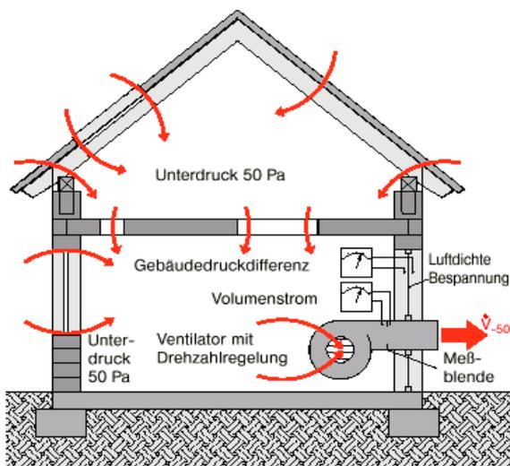
Abbildung 7: schematischer Messaufbau
