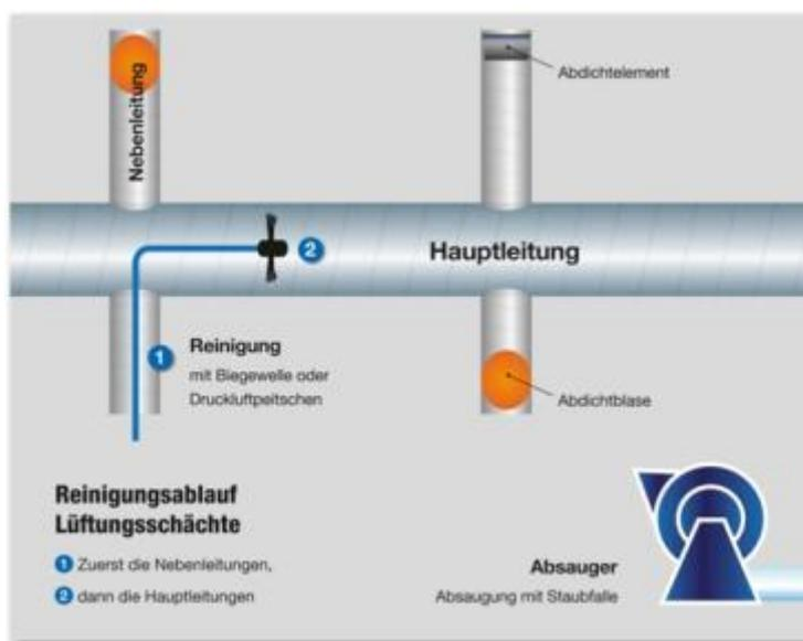
Abbildung 18 Prinzipschema einer Bürstenreinigung, Quelle: breg-rauchfangkehrer.at
