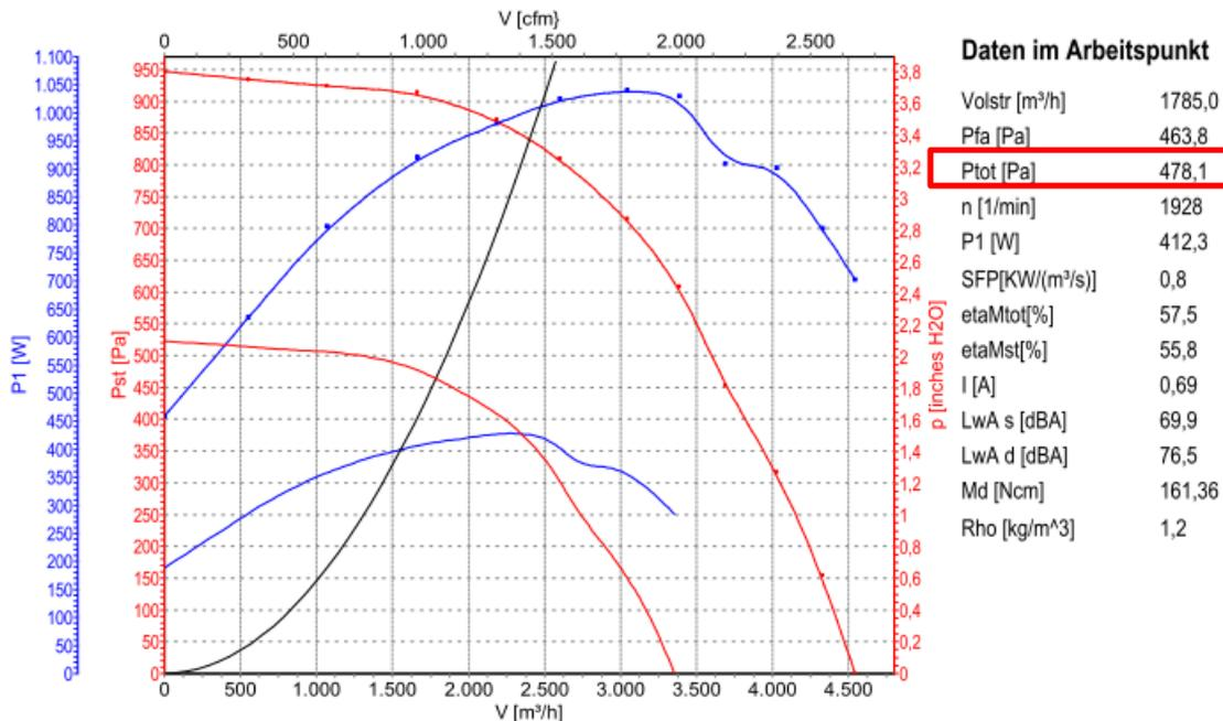
Abbildung 65: Ventilatorauslegung ZULUFT zur Berechnung der Stromaufnahme SFP, Druckverluste gesamt (intern plus extern), Lüftungsgerät Beispielprojekt
