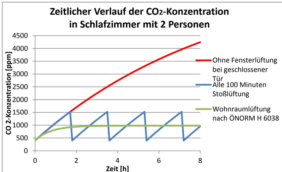
Abbildung 2: typische Verläufe der CO<sub>2</sub>-Konzentration in einem Schlafzimmer mit 2 Personen bei unterschiedlichen Lüftungssituationen (eigene Darstellung)
