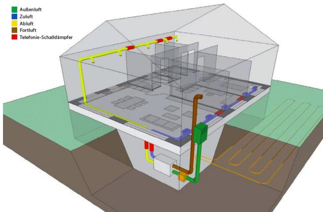
Abbildung 4: Schematische Darstellung einer Wohnraumlüftungsanlage
