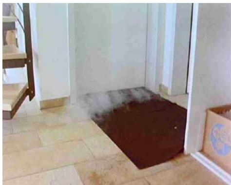
Abbildung 9: Überströmung über eine Schleiftür (Spalt zwischen Boden und Tür)
