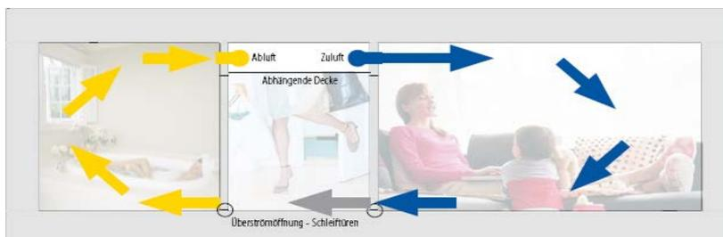
Abbildung 12: Überströmung bei Induktionslüftung (z.B. 2-mal über Schleiftür)
