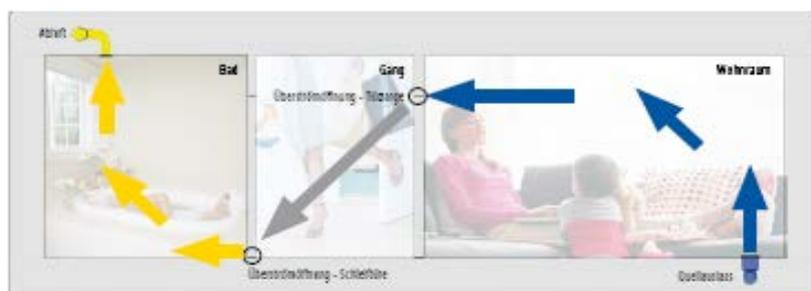
Abbildung 11: Überströmung bei Quelllüftung (Wohnraum zu Gang – oben; Gang zu Bad – unten)
