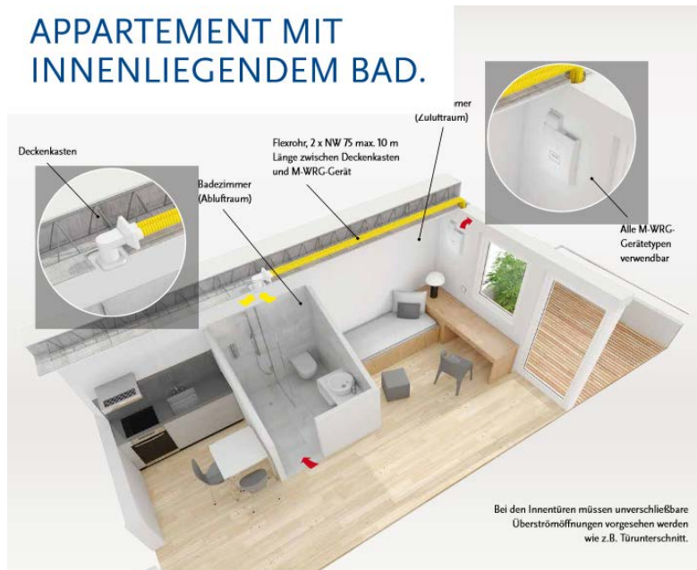
Bild 10: Einzelraumlüftungsgerät bei dem über eine zusätzliche Luftleitung eine Kaskade zwischen Zuluft- und Abluftraum geschaffen werden kann. (Quelle: Fa. Meltem)
