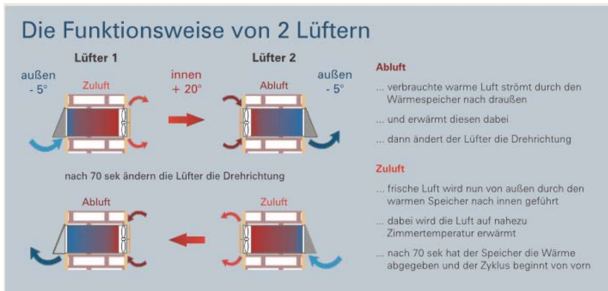
Bild 4: Funktionsweise von 2 Lüftern (Quelle: Fa. Inventer)
