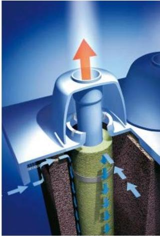
Dabei strömt die frische Verbrennungsluft entlang des Abgasstranges im Doppelrohr zum Ofen. Dabei wird die Verbrennungsluft auch etwas vorgewärmt.
