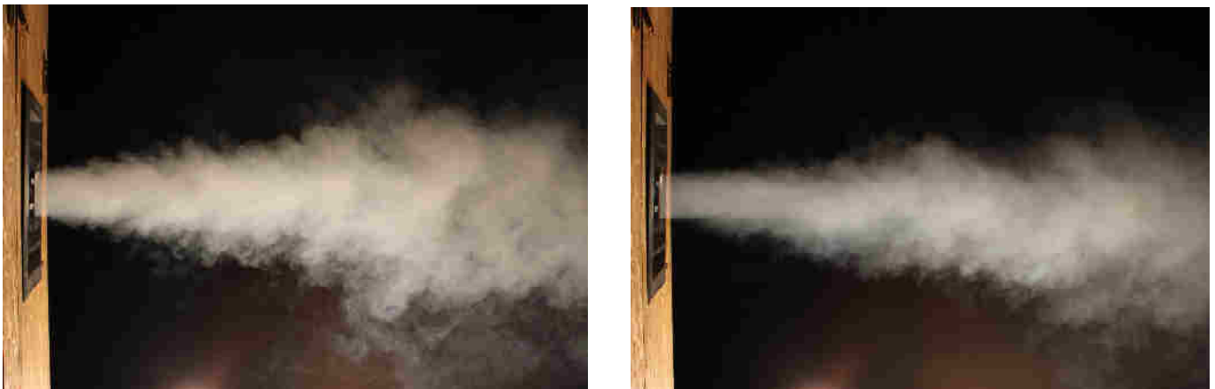
Abbildung 41 Visualisierung der Rückströmung mit Nebel in der Fortluft. Links bei 64 \text{ m}^3/\text{h} , Rechts bei 120 \text{ m}^3/\text{h} .
