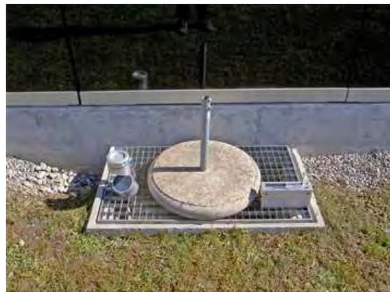
Abb. 14: Feinstaubmessungen und Luftkeimmessungen an der ebenerdigen Aussenluftfassung, Schulhaus Baden Dättwil
