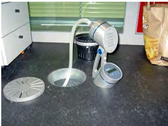
Abb. 13: Luftkeimmessung im Zuluftstrom, Schulhaus Baden Dättwil
