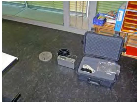
Abb. 12: Feinstaubmessung im Zuluftstrom, Schulhaus Baden Dättwil
